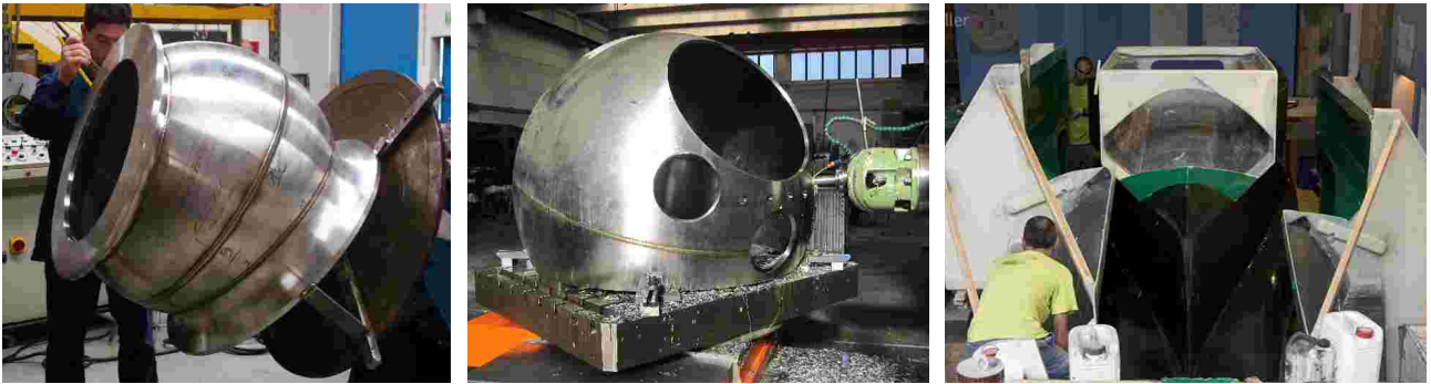
Procés de soldadura de les 4 parts de l'esfera petita. Mecanització dels forats de l'esfera gran. Motllos del carenat.
