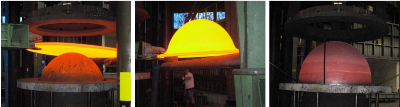
Procés de conformació d'una de les semiesferes d'acer del buc de pressió de l'ICTINEU 3
